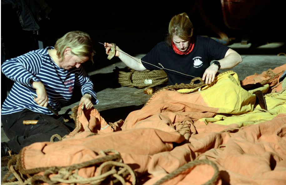
Fig. 1. Sejlsyning, hørsejle til Havhingsten fra Glendalough . Sejlmager Hansens eftf. Foto: Werner Karrasch, Vikingeskibsmuseet.
